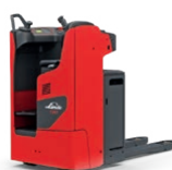
T20 - T25 R Istuen ajettava lavansiirtovaunu Nostokkyky: 2.0 t - 2.5 t
