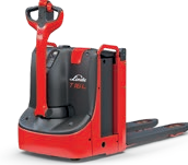
T16 L Kevyt kävellen ohjattava lavansiirtovaunu Nostokkyky: 1.6 t
