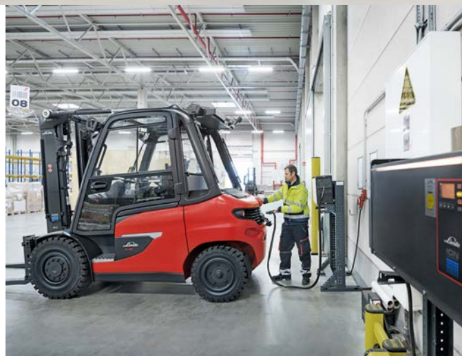
Sähkötrukkien voimalinjat ovat Linden omaa suunnittelua ja tuotantoa. Huoltovapaa akseli on varustettu kahdella itsenäisellä pyörämootorilla.
